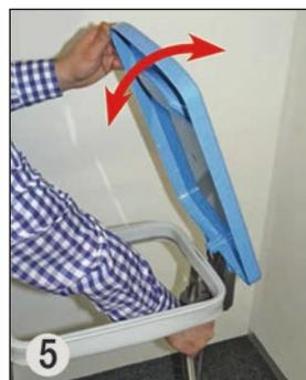
5. Durch Hin- und Herbewegen des Deckels und Drücken gegen die Schubstange von links diese aus den Deckelösen führen.
